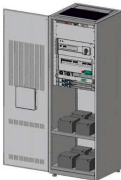
Рисунок 2 – Одна из конфигураций PS220-27/48-80
